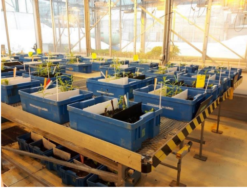
Photos de tests permettant de vérifier le système racinaire et la capacité de purification rhyzosphérique d'espèces végétales.
