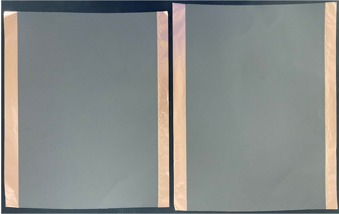
Feuillets d'anode fabriqués à partir du matériel d'anode actif de NMG présentement testé par Panasonic Energy.
